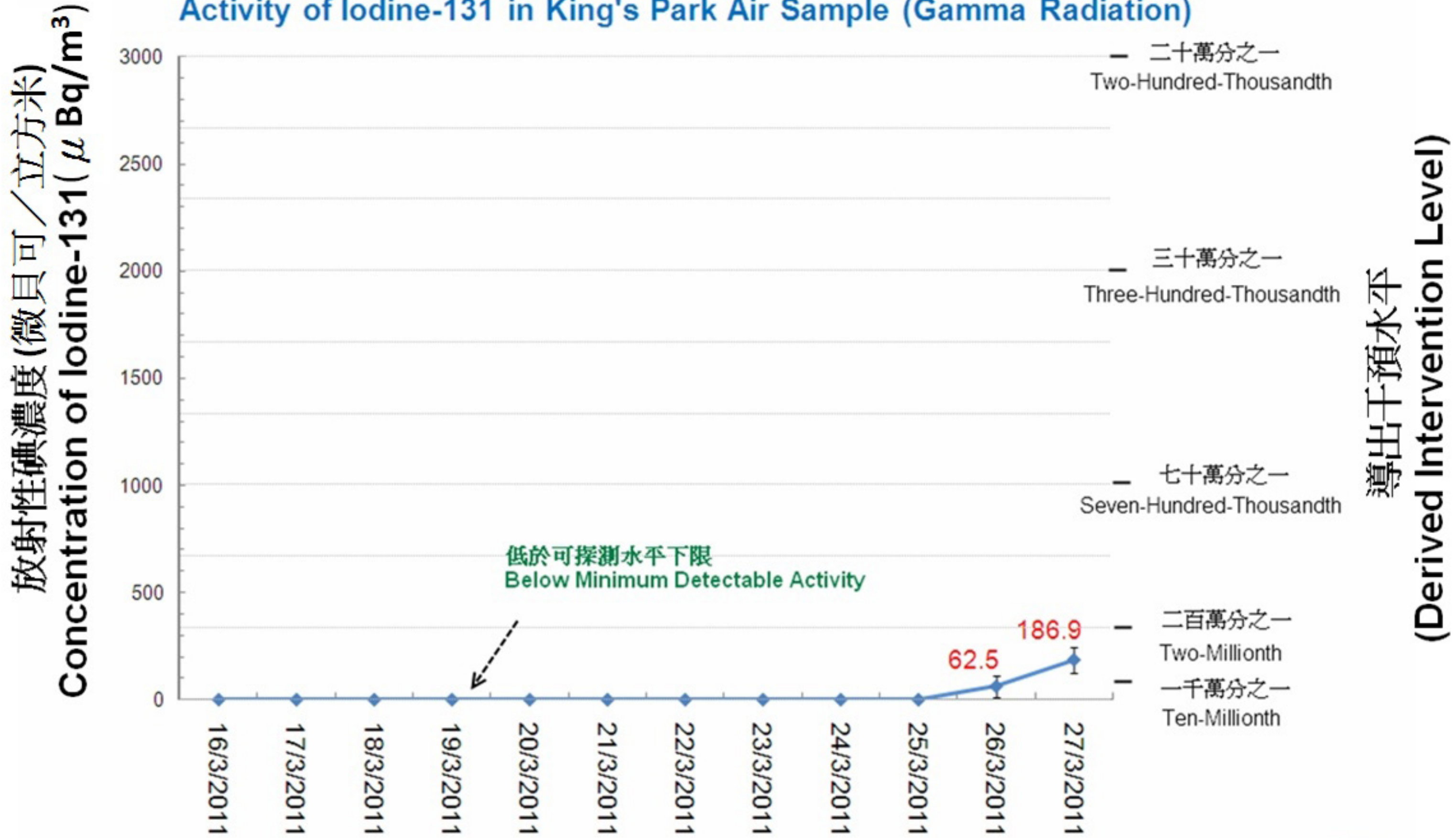
圖一 京士柏空氣樣本中碘-131的放射性濃度。圖中的日期表示採集樣本的開始日期。例如3月26日的數據表示由3月26日中午至3月27日中午所採集樣本的量度結果。
