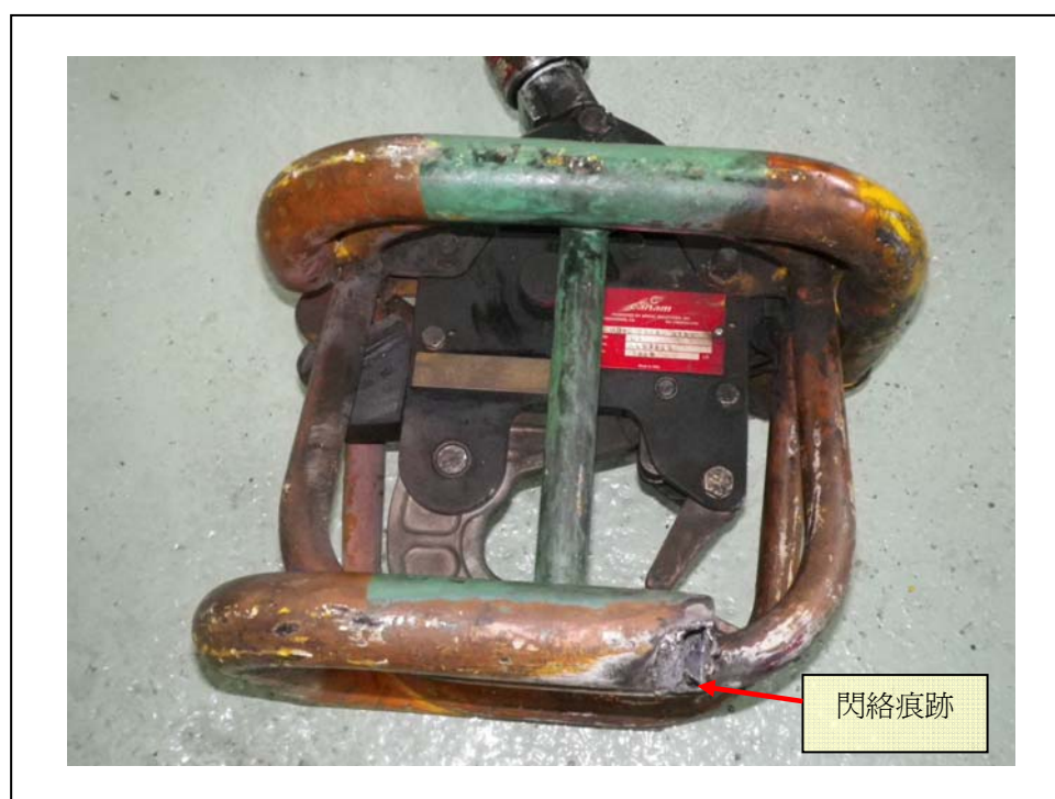
圖二： 長索底部配備的遙控鉤呈焦黑狀態，明顯有被燒焦及發生過閃絡的痕跡。
