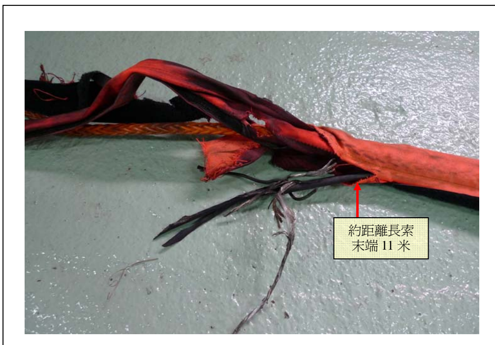
圖一： 直升機所用的“長索”末端，外層約11米長的一段防護尼龍布料受到嚴重損壞，而於這外層內的電線其中一大部分更完全消失。
