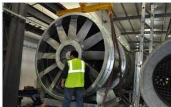
隧道通風風機測試
