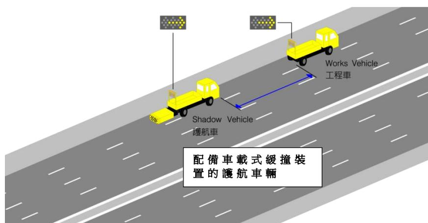
圖二：工程車輛須由護航車輛護航
