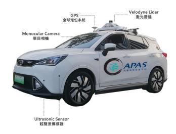
「創新科技嘉年華 2020」將於十二月二十三至三十一日在線舉行,展出多項本 地創新發明和科研成果。圖示由汽車科技研發中心研發的「電動車智能自動泊 車系統」。該項發明配備全球定位系統、單目相機、超聲波傳感器和激光雷達功 能,讓電動車在無人駕駛下自動泊入車位。
