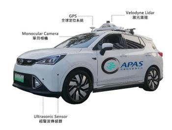
「創新科技嘉年華 2020」今日(十二月二十三日)至十二月三十一日在線舉行,展出多項本地創新發明和科研成果。圖示由汽車科技研發中心研發的「電動車智能自動泊車系統」。該項發明配備全球定位系統、單目相機、超聲波傳感器和激光雷達功能,讓電動車在無人駕駛下自動泊入車位。
