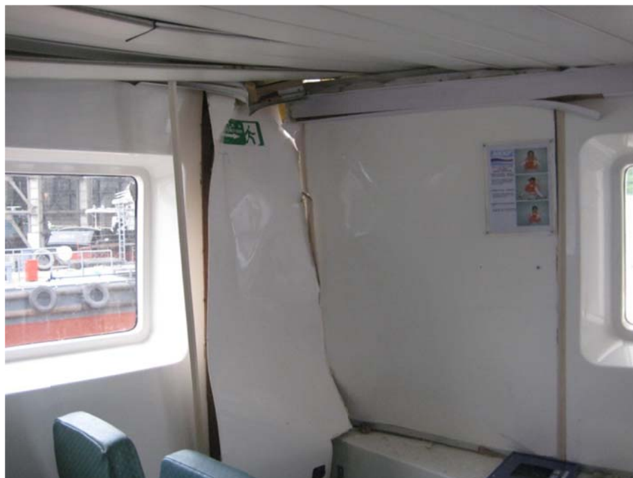
圖五：海泰號相撞部位的船體受損圖像
