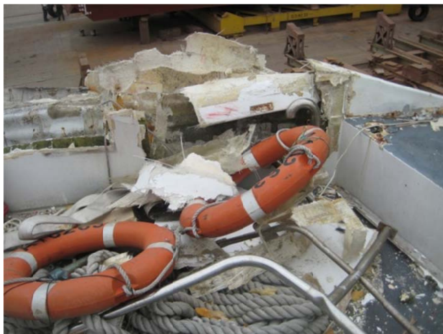
圖四：海泰號相撞部位的船體受損圖像
