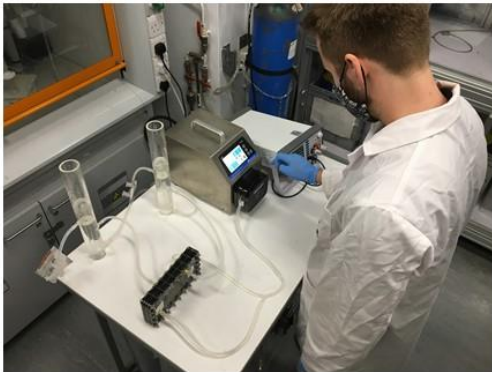
Test rig for assessing the performance of a prototype active flow membraneless electrolyzer (AFME). 研究人員正在測試使用液流無膜電解系統。
